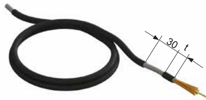
Фиг. 25 EMС кабел преди свързване към кабелен клеморед изолиран до 30 mm. Размер „t“ отговаря приблизително на разстоянието от скобата за закрепване до кабелната клема.
