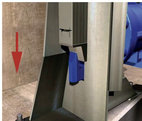
Μανδάλωση (εσωτερική όψη)
